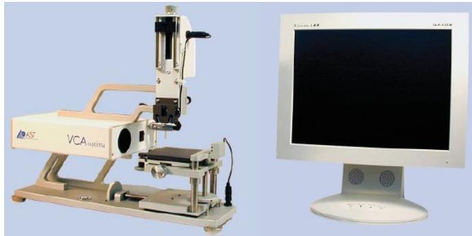
VCA-Optima-Systeme eignen sich für die Forschung, zur Qualitätskontrolle in der F & E und der prozessbegleitenden Fertigung. Die Systeme reichen vom einfachen Optima bis zum voll ausgestatteten Optima XE. Zu den Funktionen gehören z. B. manuelle und dynamische Berechnung der Kontaktwinkel, Bilderfassung, motorisierte Spritze, Oberflächenenergie-Analyse und Tropfenkontur-Analyse.
